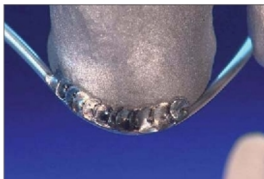
Abb. 3: Das phaser-Schweißen im Mikrobereich wurde weiter optimiert – Randkorrektur mithilfe eines 0,35 mm starken Zulege drahts.
